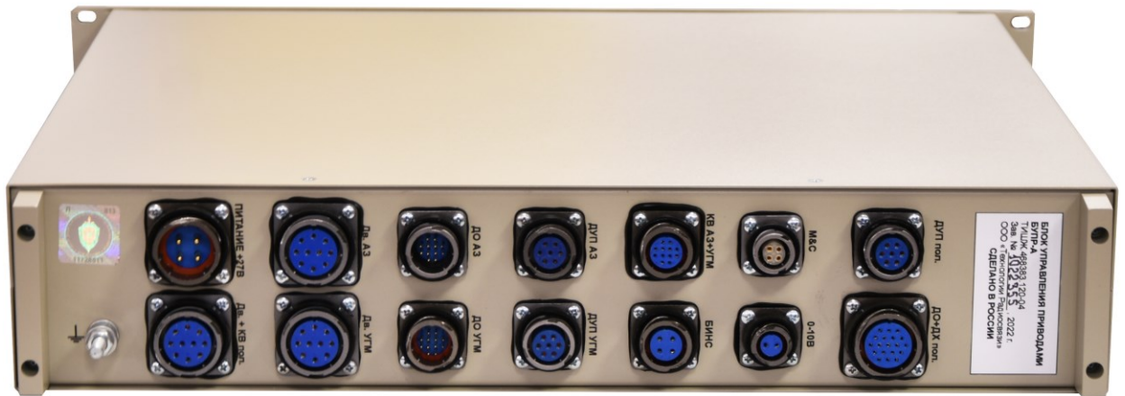
Рисунок 10 – Внешний вид БУПР-А (лицевая и задняя панель)
