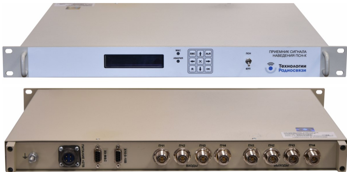
Рисунок 9 – Приемник сигнала наведения ПСН-К
