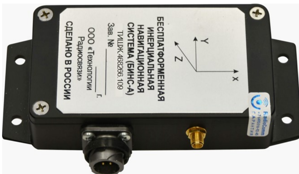
Рисунок 11 – Внешний вид БИНС-А ТИШЖ.468266.109
