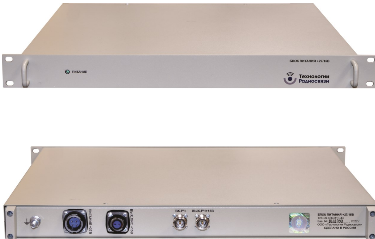
Рисунок 7 – Внешний вид блока питания +27/15 В
